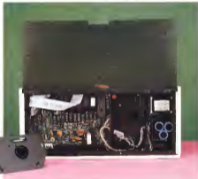
L'interno del CI-4400: in alto la sezione di alimentazione e la scheda di controllo; in basso il sistema di fotocamera innalzato dalla propria sede.
